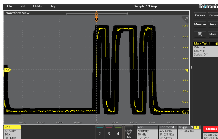
基于金标准参考信号的极限模板测试
