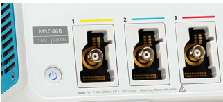
FlexChannel 技术实现了较大的灵活性。依据连接的探头类型，每个输入可以配置成一条模拟通道或 8 条数字通道。
