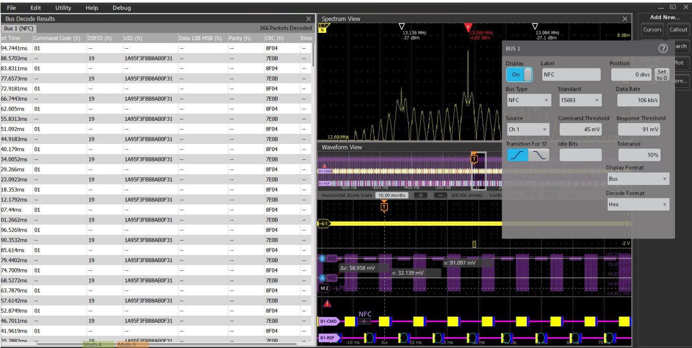
NFC 软件选项允许您解码和搜索数字 NFC 位流，以便在单个仪器中执行 NFC 模拟/RF 和数字预一致性、调试以及故障排除。
