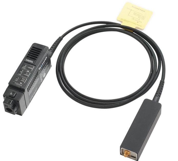
泰克 TIVP 系列 IsoVu™ 测量系统提供了电流隔离测量解决方案，在存在大的共模电压时可以准确地解析高达 2,500 Vpk 以上的高带宽差分信号，在带宽范围内提供了同类优秀的共模抑制性能。
